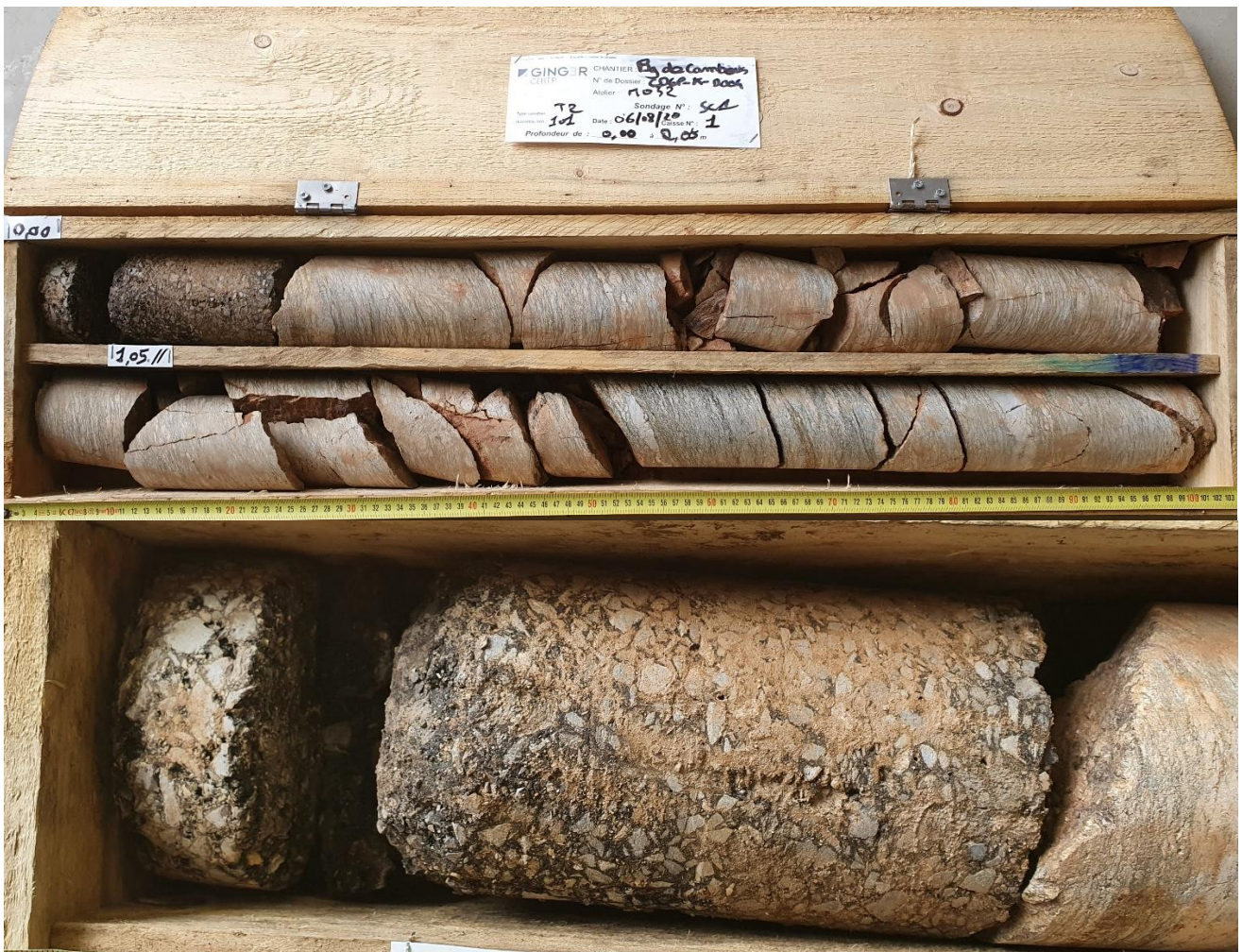
Figure 3 : Sondage carotté dans l'axe du barrage (de 0 à 2,0 m en haut et de 0 à 0,2 m en bas)
