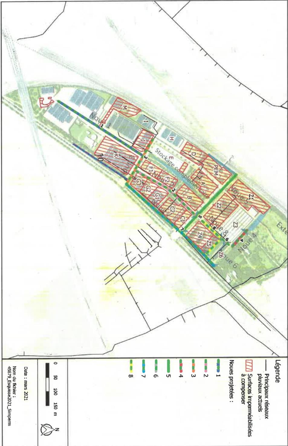
Figure 20 : Localisation des surfaces imperméabilisées à compenser (lots concernés par des opérations de démolition / reconstruction ou de construction de bâtiments neufs, surfaces nouvellement imperméabilisées)
