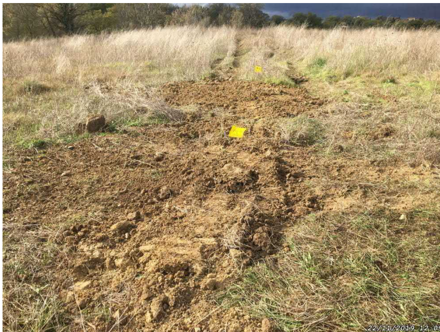
Photo 14. Sondage MAR1-101_S5 rebouché
