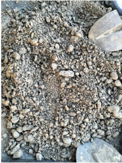
Formulation BCR2 - Gâchée W1 = 6,5% Photographie 8 : BCR 2 - Gâchée G1 pour W1
