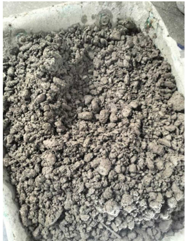
Formulation BCR2 - Gâchée W2 = 7,2% Photographie 9 : BCR 2 - Gâchée G1 pour W2
