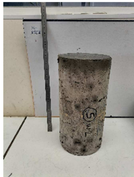
Eprouvette BCR1 - W2=7,2%
