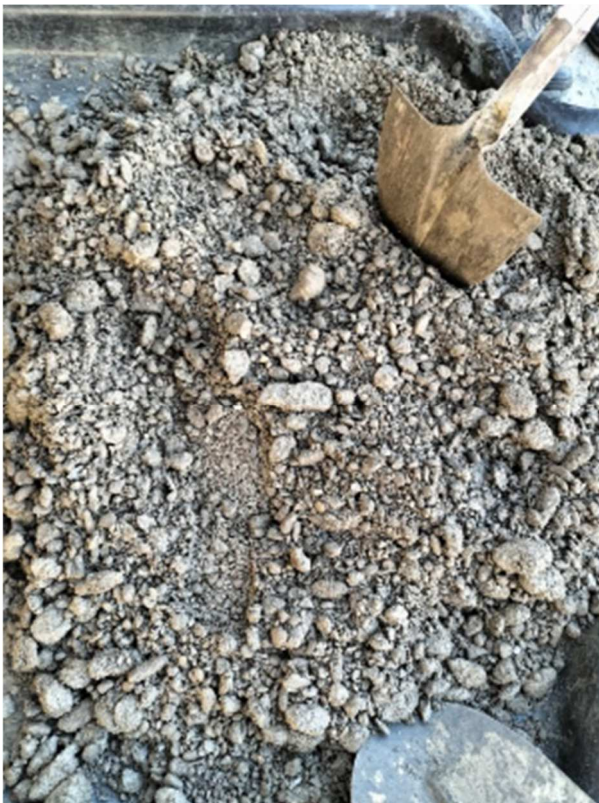
Formulation BCR2 - Gâchée W2 = 7,2% Photographie 9 : BCR 2 - Gâchée G1 pour W2
