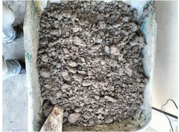
Formulation BCR2 - Gâchée W1 = 6,5% Photographie 8 : BCR 2 - Gâchée G1 pour W1
