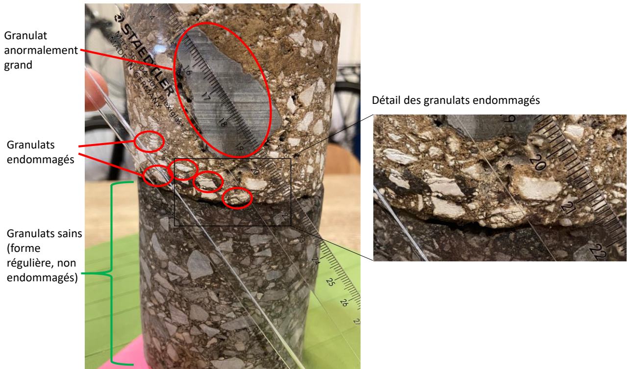
Figure 42 : Défaits observés sur SC5
