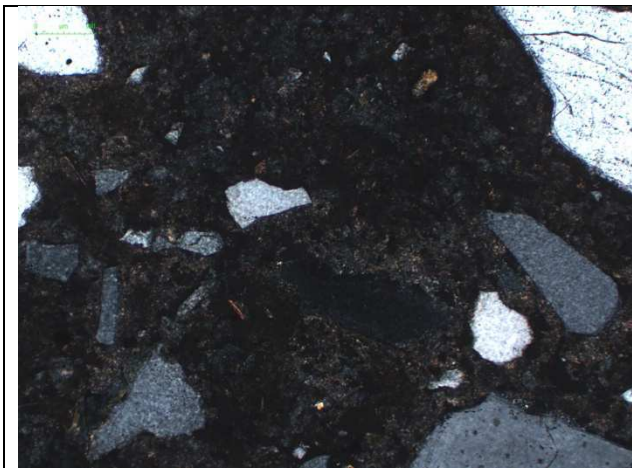
Figure 14 : (x100) (LPA) la fraction sable est constituée de grains de quartz majoritaires, anguleux donc probablement issus d'un processus de concassage.
