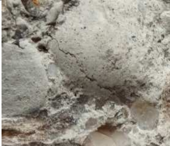
Figure 30: (vue à la loupe binoculaire) le liant est blanchâtre, il présente des fissures dans l'empreinte laissée par la cassure due à la préparation de l'échantillon.
