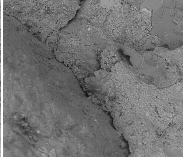
Figure 33 : aspect identique sur l'échantillon 1179-II. A noter l'espace libre entre le grain de quartz et le liant traduit une mauvaise adhérence granulat/liant.
