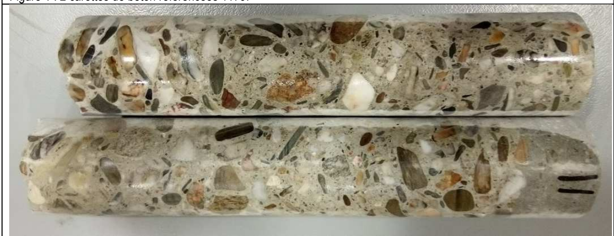
Figure 2 : 2 carottes de béton référencées 1179. Le béton a été mouillé pour mettre en évidence les différents faciès pétrographiques présents.
