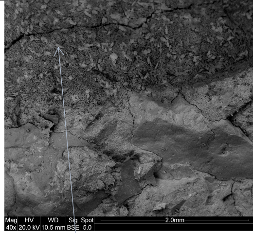
Figure 31 : (vue au MEB) zone similaire à celle-ci-contre, les grains de sable du liant de l'empreinte sont des grains concassés.
