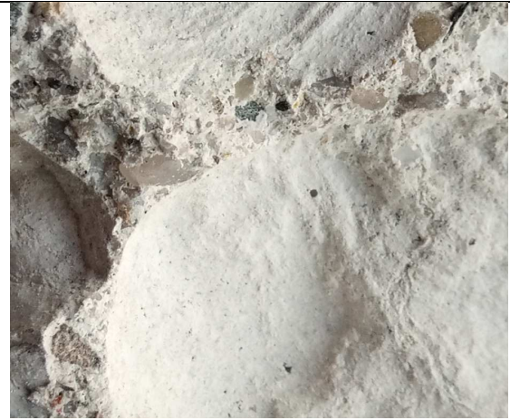
Figure 7 : carotte 1179-II détails de deux empreintes et de la zone de liant en cassure fraîche. Le liant est très clair.
