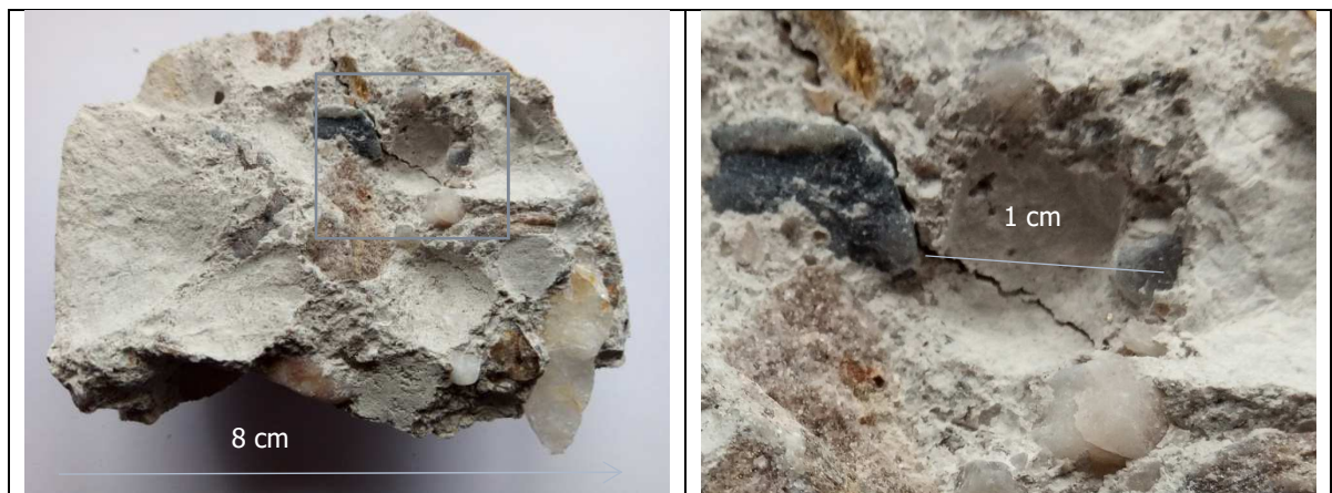
Figure 5 : échantillon 1179-I : fragment de la carotte I permettant de voir le déchaussement des granulats dû à l'obtention de la cassure fraîche et une fissuration.
