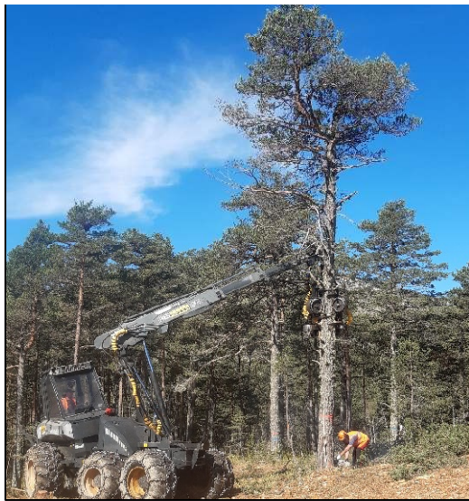
Exemple de dépose délicate d'un tronc creux au grappin hydraulique
