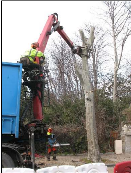
Exemple de dépose délicate d'un tronc creux au grappin hydraulique
