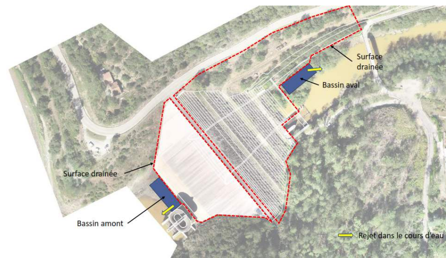
Figure 57 : Implantation des bassins sur le site du barrage de Sainte-Cécile d'Andorge et surface drainée
