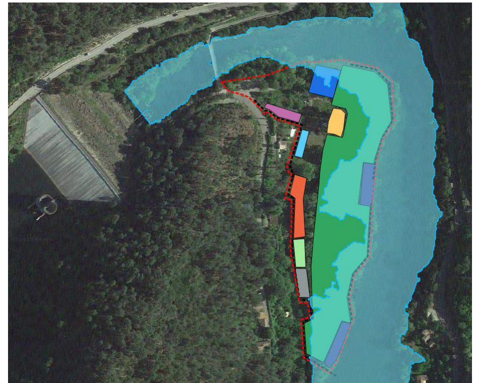
Figure 41 : Emprise de la crue centennale et installation de chantier
