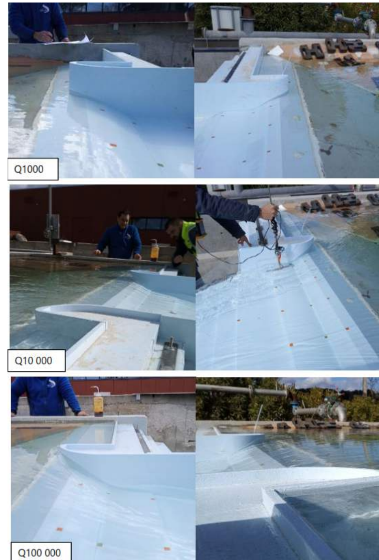
Photographie 6 : Simulation des écoulements dans l'entonnement sur le modèle physique
