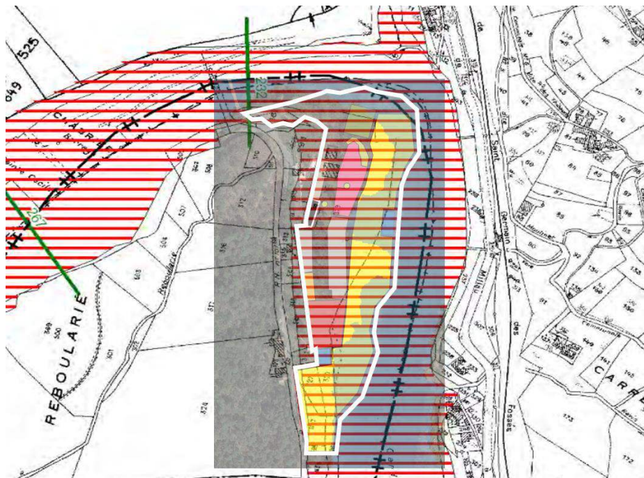
Figure 40 : Installation de chantier et PPRI
