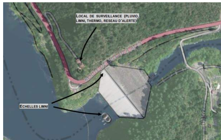
Figure 62 : Localisation du local de surveillance et des échelles limnimétriques
