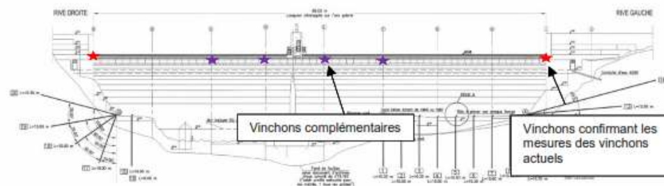
Figure 23 : Implantations des nouveaux vinchons en galerie de barrage
