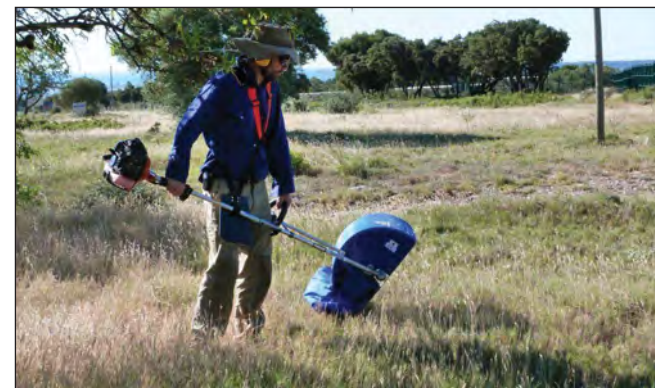
Utilisation de la moissonneuse portative pour récolter les semences d'une pelouse sèche dans les Corbières (11)
