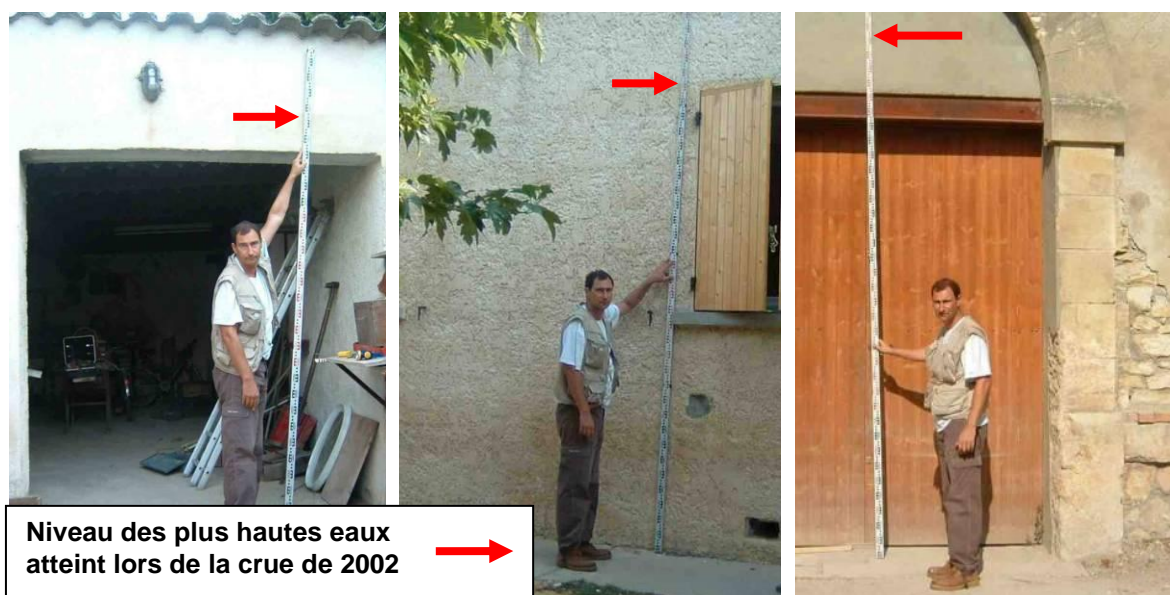
Figure 14 : Hauteur des plus hautes eaux lors de la crue de 2002 (Source : PPRi d'Aramon)
