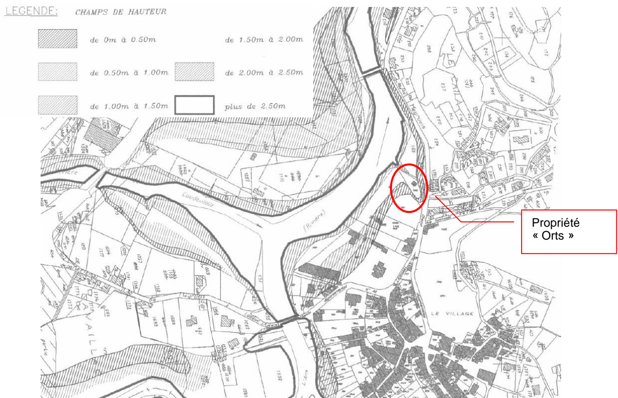
Figure 16 : Carte des hauteurs de submersion modélisées à Avèze pour une crue d'occurrence centennale (source : Safège, 1996)
